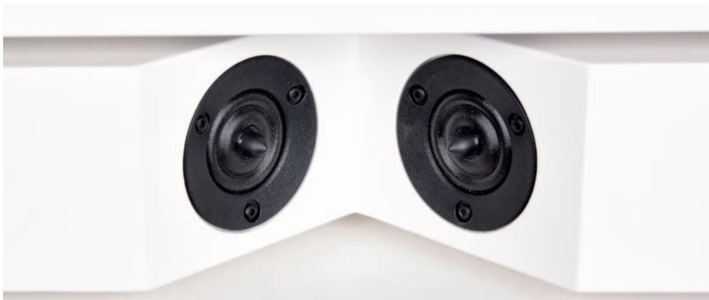
Die 30-mm-Version der Keramikkalotte gehört zum Hochauflösendsten überhaupt, will aber vom Entwickler abstrahltechnisch beherrscht werden. Denn Keramik ist ultrahart und beginnt bei hohen Frequenzen dementsprechend zu bündeln.
