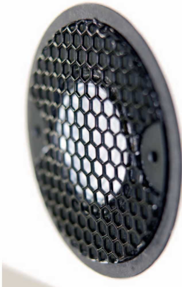
Die 30-mm-Version der Keramikkalotte gehört zum Hochauflösendsten überhaupt, will aber vom Entwickler abstrahltechnisch beherrscht werden. Denn Keramik ist ultrahart und beginnt bei hohen Frequenzen dementsprechend zu bündeln.
