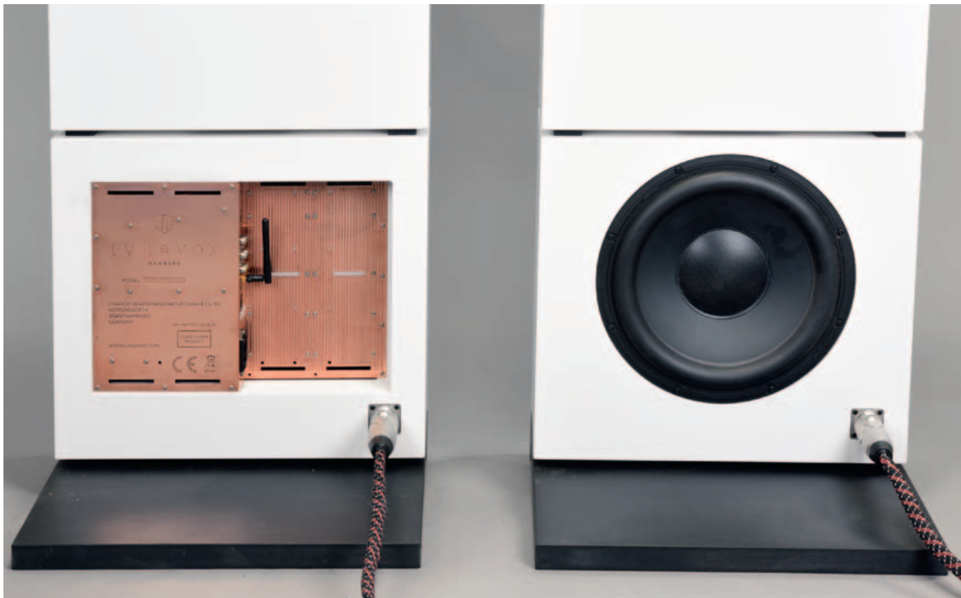
Ungleiche Brüder: Während die rechte Aktivbox die Elektronik hinter einer Kupferplatte nebst Endstufen, DSP, Streamer und Netzwerk-Intelligenz beinhaltet, nutzt die linke das untere Gehäuseeteil für den Subwoofer. Da er ohnehin nur im nicht ortbaren Bereich spielt, hat das auf die Abbildung keinen Einfluss. Für die Verbindung beider Skulpturen sorgen ein hauseigenes Mehrkanalkabel und Speakon-Verbinder.
