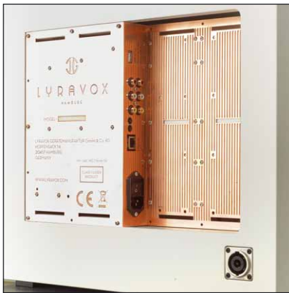
Hinter der Kupferplatte verstecken sich Streamer, DSP und Endstufen. Der wichtigste Anschluss des Panels bleibt die Ethernetbuchse
