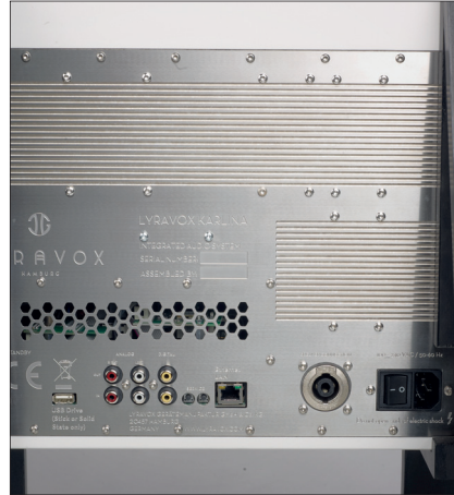
Unter der gleichzeitig als Kühlkörper fungierenden Abdeckung befindet sich die leistungsfähige Steuerzentrale
