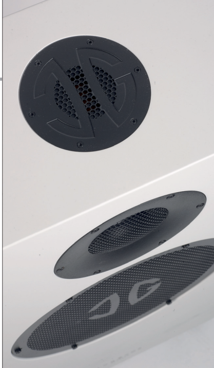
Der Superhochtöner strahlt nach oben ab und sorgt für die Luftigkeit in den obersten Lagen
